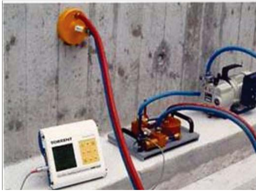
図3 表面透気試験機
