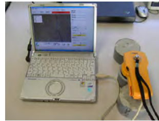
左 ひび割れ幅測定状況 下 ひび割れ幅頻度分布
