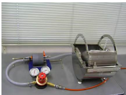
透気試験状況
