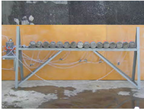
透水試験状況
