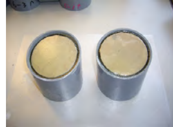
左上 採取したコアをスライスした状態 右上 エポキシ樹脂充填状況 下6枚 無処理試験体の断層毎のひび割れ状況
