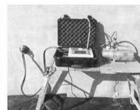
写真-6 表層透気試験(施工後)
