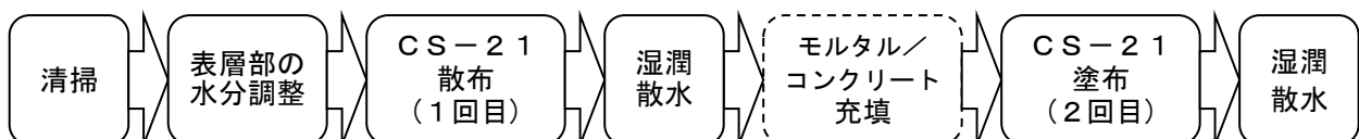
工法概要図：開口部処理
