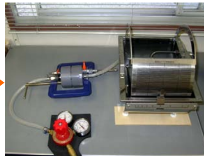
透過空気量測定状況
