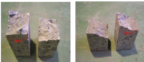
CS-21: 200g/m²塗布供試体の打継ぎ面以外での破断面状況
