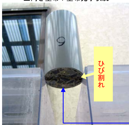
上向き塗布：塗布完了状況
