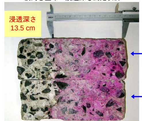
上向き塗布：浸透深さ測定状況
